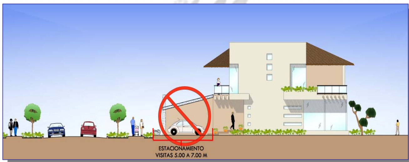
FIG.11 CONDICIONANTES PARA ESTACIONAMIENTOS DE LOTES UNIFAMILIARES
